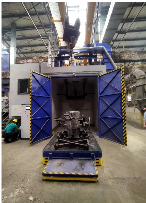
Obr. 3 Uzavřená zděná varianta modifikační kabiny pro pánve do 6 tun (součástí zařízení je samo-zajíždějící modifikační vůz o nosnosti 10 tun a křídlové vrata s elektrickými pohony)
