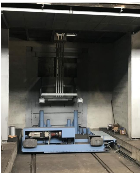
Obr. 2 Uzavřená zděná varianta modifikační kabiny pro pánve do 30 tun
