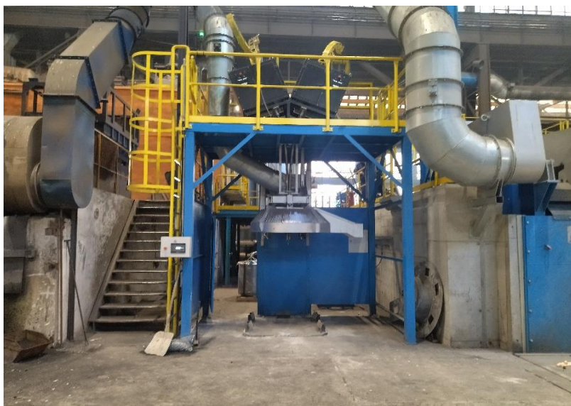
Obr. 4 Otevřená varianta modifikační kabiny pro pánve do 6 tun
