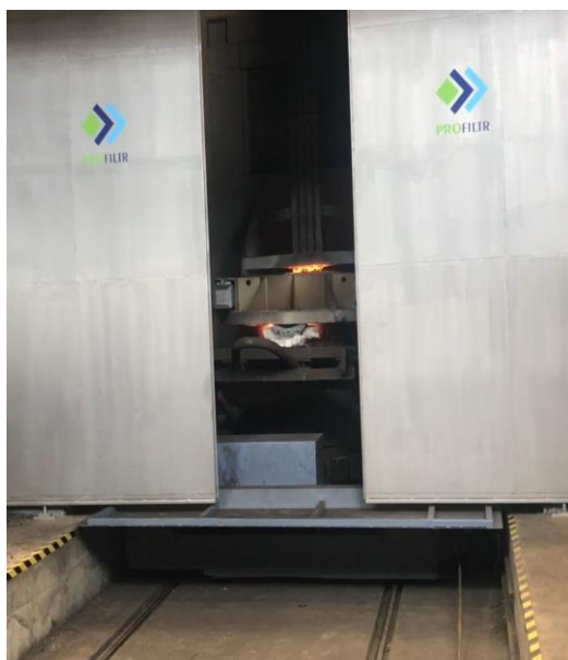
Obr. 2 Uzavřená zděná varianta modifikační kabiny pro pánve do 30 tun
