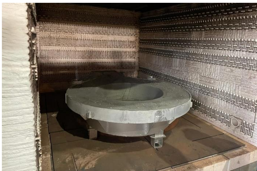
Obr. 6 Sintrace vyzdívky víka modifikační kabiny
