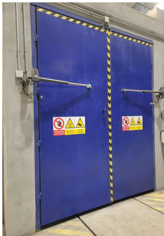
Obr. 3 Uzavřená zděná varianta modifikační kabiny pro pánve do 6 tun (součástí zařízení je samo-zajíždějící modifikační vůz o nosnosti 10 tun a křídlové vrata s elektrickými pohony)
