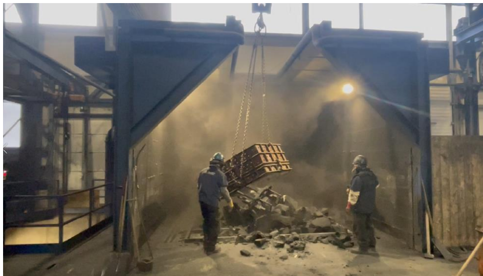
F2, odprášení velkého vytloukacího roštu.
