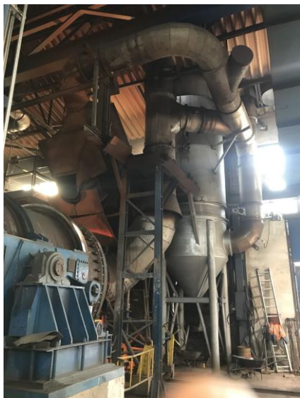
Spalinový výměník s využitím odpadního tepla
