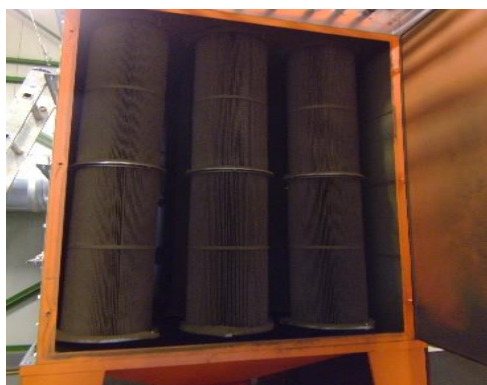
Dodávka a výměna patronových filtrů i pro konkurenční odsávací zařízení.
